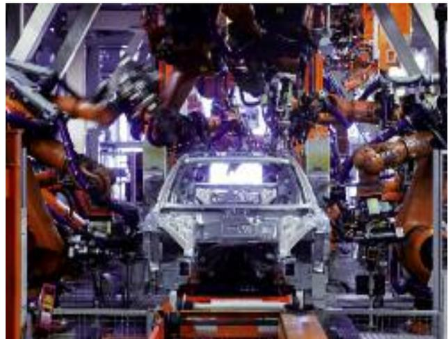
Nach kurzem Fußmarsch durch die Werkshalle sind wir bei einer roboterbetriebenen Fertigungsstraßen angekommen. Hier wurden die einzelnen Karosserieteile von Fertigungsrobotern verschweißt, genietet, geklebt und gelötet.
